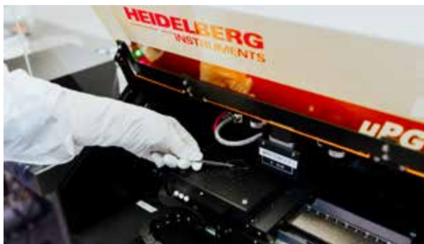
Heidelberg μPG ir tiešs rakstītājs, litogrāfijas sistēma, kurai nav nepieciešamas maskas. Rakstītājā izmanto UV lāzera staru, kuru selektīvi pakļauj virsmām uz parauga. Foto: LU CFI arhīvs.
