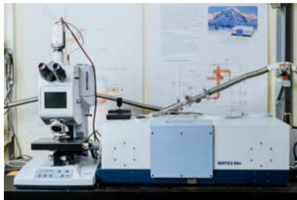
Infrasarkanā starojuma Furjē transformācijas vakuuma spektrometrs Bruker VERTEX 80v dod iespēju veikt FTIR analīzi organiskiem un neorganiskiem materiāliem, kristāliem, pusvadītājiem. Foto: LU CFI arhivs.
