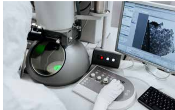
TEM FEI Tecnai G2 F20 ir elektronu mikroskops ar visaugstāko izšķirtspēju Latvijā. Tā mērījumi dod augstas izšķirtspējas informāciju par parauga sastāvu, struktūru un morfoloģiju. Foto: LU CFI arhīvs.
